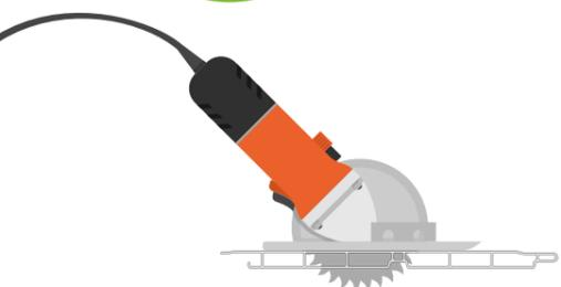
Corte as lâminas, uma por uma, na largura desejada.
