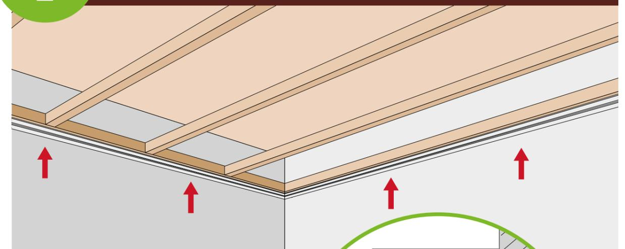
Em seguida, fixe **os clips PVC** de sustentação (do tipo **U de partida**) na moldura de **madeira** em torno do ambiente de trabalho.
