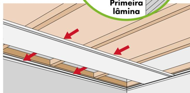
Fixar a lâmina com os **parafusos Ø 3,5 mm x 25 mm** na sua lingüeta larga na **interseção** de cada ripa de madeira (ou trilho de metal). Os parafusos estão ocultos pela sobreposição da próxima lâmina.
