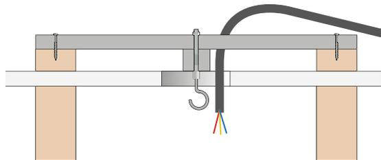
Para **iluminação suspensa pesada** (tipo **candelabro**), recomenda-se fixar este elemento pesado na estrutura de suporte do forro com uma travessa adequada, ou mesmo na estrutura do telhado.
