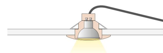
Para uma **iluminação embutida** (tipo **spot**), o seu peso não deve exceder 2 kg. A potência elétrica é de 20 W no máximo.
