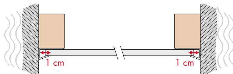
**Atenção**, o comprimento das lâminas deve permanecer **menor** que a dimensão medida entre paredes (entre 2 e 3 cm pelo menos) para facilitar a instalação e evitar a quebra e queda deste último durante um **evento sísmico**.
