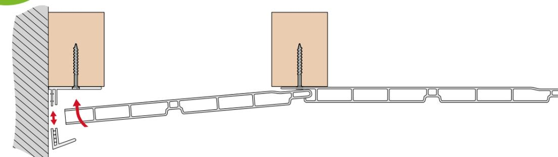
Ajustar e cortar a **última lâmina** em todo comprimento para ajustar a distância (menos 1 cm) entre a parte inferior do clip de sustentação (**U clipável UCLIP** por exemplo) e a penúltima lâmina, encaixe-a e feche o **UCLIP**.
