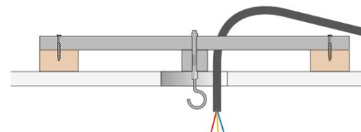
Para uma **iluminação suspensa pesada** (tipo **lustre**), se preconiza fixar este elemento pesado na estrutura sustentadora do forro com uma cruz adequada ou até mesmo na estrutura do telhado.
